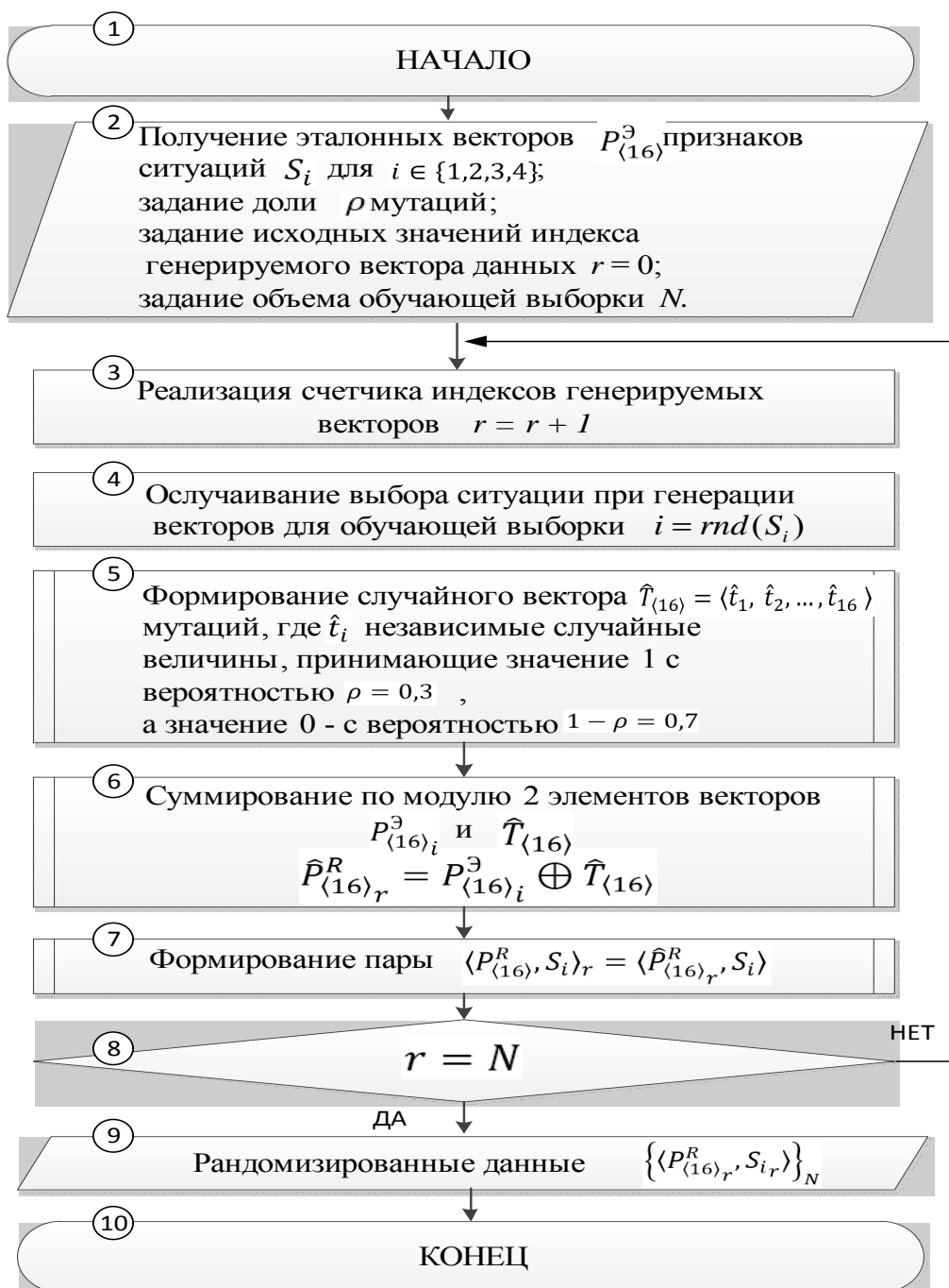
Рис. 2. Схема рандомизации эталонных векторов признаков ситуаций для формирования обучающей выборки требуемого объема N
