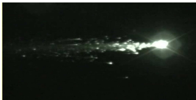
Рис. 1. Разрушение блока «А» РН типа «Союз» на пассивном участке траектории
