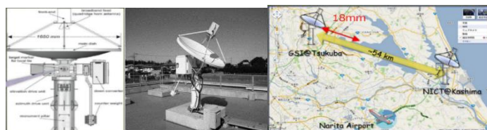
Рис. 1. Приемная антенна малогабаритного радиоинтерферометрического комплекса с длинной базой диаметром около 1,5 м
